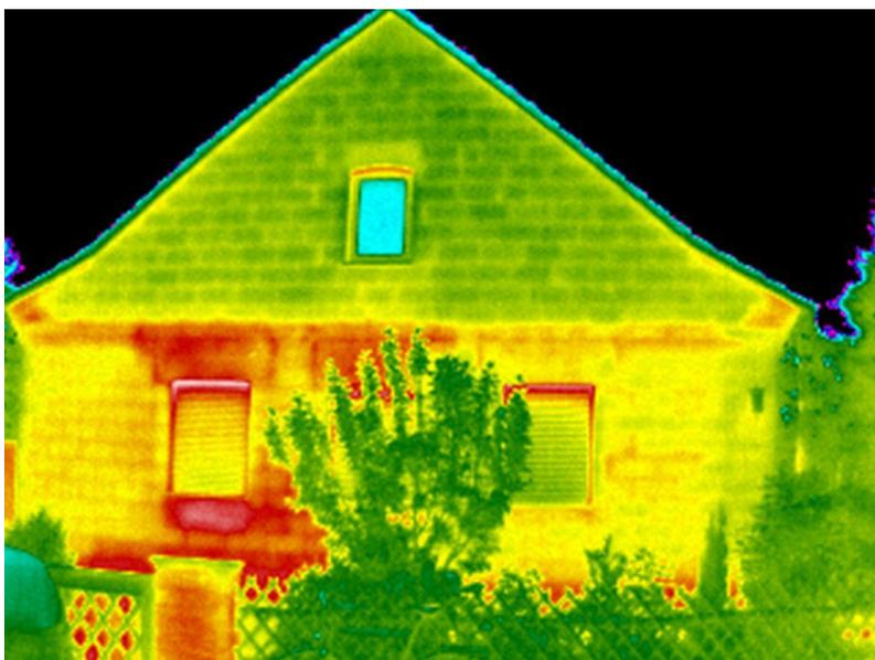
Im Wärmebild lässt sich erkennen, dass über Rollladenkästen und Fensterbänke der linken Haushälfte viel Wärme nach draußen gelangt (im Bild rot gefärbt).
